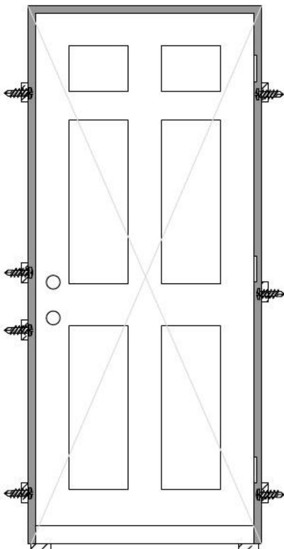
Le seuil doit être horizontal et au niveau.
